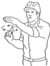
3 Levantar la carga lentamente
